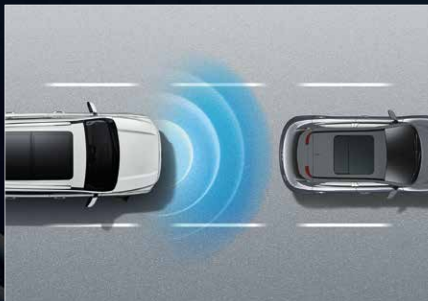
AEBS ระบบช่วยเบรกฉุกเฉินบนทางตรงและทางแยก MEB / L-AEB ระบบช่วยเบรกฉุกเฉินที่ความเร็วต่ำ FCW ระบบช่วยเตือนเมื่อเสี่ยงต่อการชนด้านหน้า
