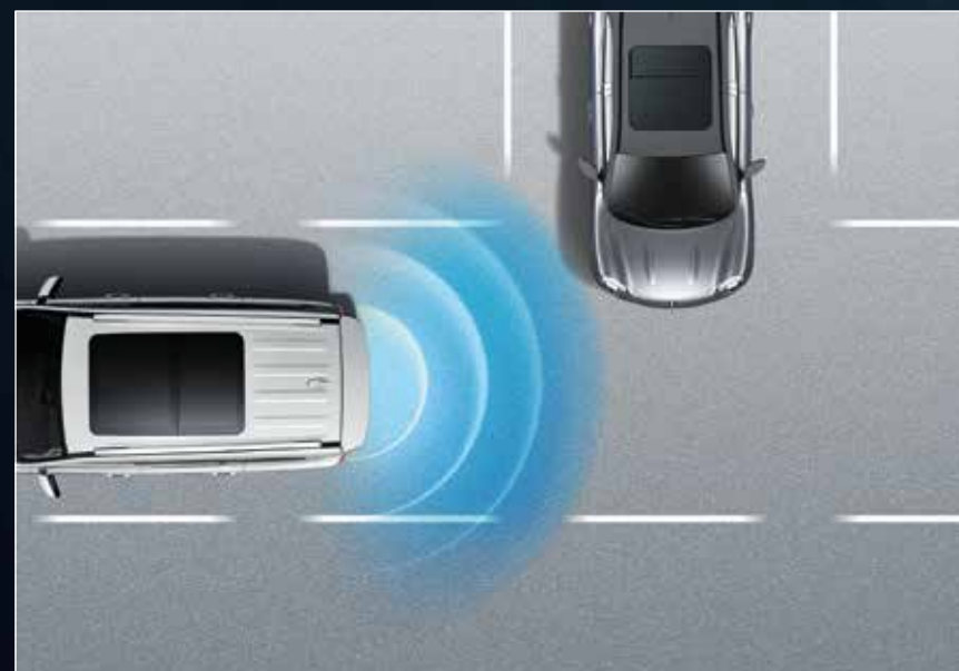
RCTA ระบบช่วยเตือนเมื่อมีรถในจุดอับสายตาขณะถอยหลัง RCTB ระบบช่วยเบรกเมื่อมีรถในจุดอับสายตาขณะถอยหลัง
