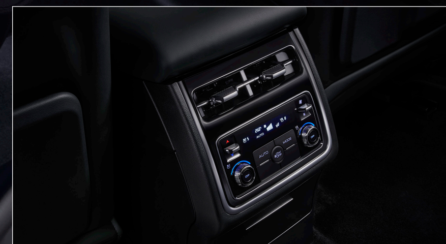
2 nd Row Ventilation Control Panel* ระบบควบคุมการระบายอากาศ และระบายความร้อนเบาะแถวที่ 2
